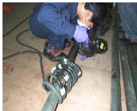
รูปที่ 31 แสดงการซั่งน้ำหนักร การตรวจสอบ Surface Defects โดยการท่า MT การวัดค่า Run out และการแก้ไข Run Out ของ Through Bolts กรณีค้ำที่วัดได้ไม่ผ่านเกณฑ์
