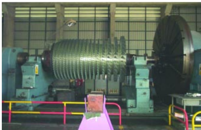
รูปที่ 14 แสดงการ Check Rotor Dimension และ Run out บนแท่นกลึง Skoda ณ กองโรงงานหนองจอก
