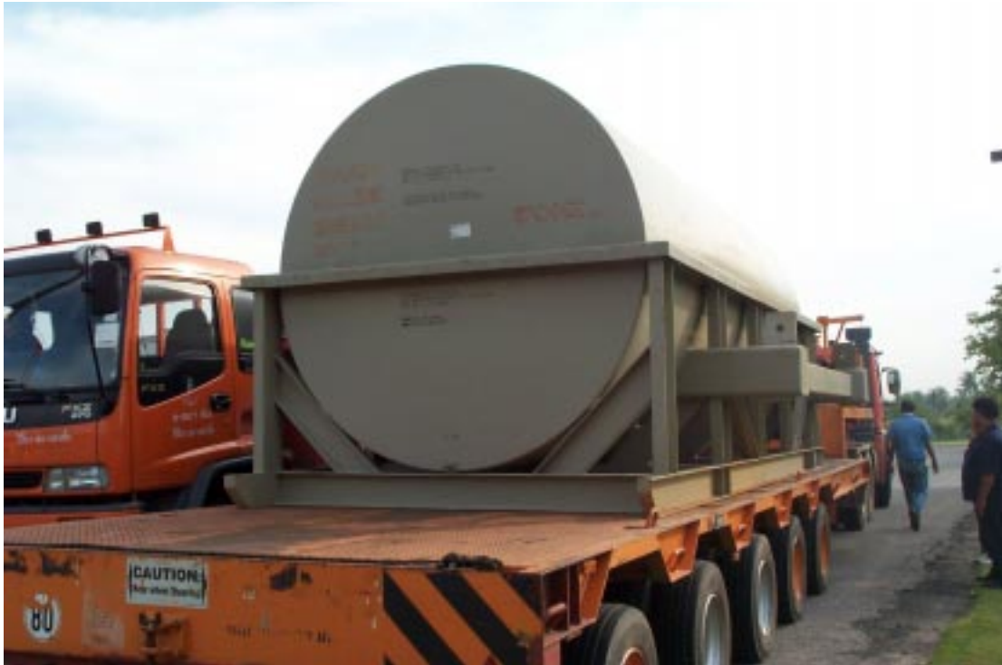
รูปที่ 33 แสดงการขนส่ง Rotor ไปที่ site โดย Rotor ถูกบรรจุอยู่ใน Capsule
