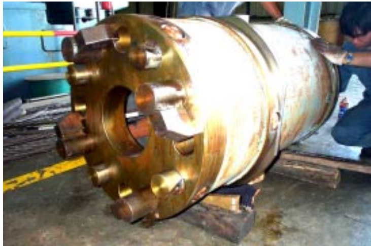
รูปที่ 17 แสดง การใช้ Special Tool ประกอบกับ Torque tube MW701D rotor เพื่อใช้ในการ Check Run Out Turbine Rotor
