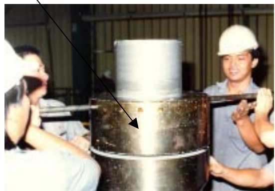
รูปที่ 24 แสดงลักษณะของการยึด Through Bolts ของ Gas Turbine Rotor V93.2 (KWU)
