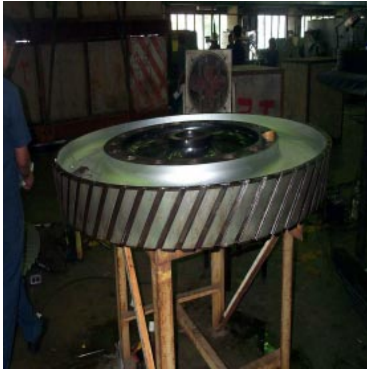
รูปที่ 27 แสดง Compressor Wheel ของ PG9001E หลังจากดำเนินการถอด Compressor Blade ออกไปแล้ว
