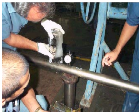
รูปที่ 30 แสดงการตรวจสอบค่า Disc Mass Unbalance โดยใช้วิธี Check แบบ Dynamic
