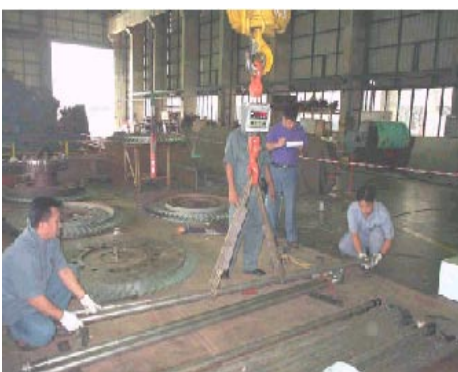
รูปที่ 31 แสดงการซั่งน้ำหนักร การตรวจสอบ Surface Defects โดยการท่า MT การวัดค่า Run out และการแก้ไข Run Out ของ Through Bolts กรณีค้ำที่วัดได้ไม่ผ่านเกณฑ์
