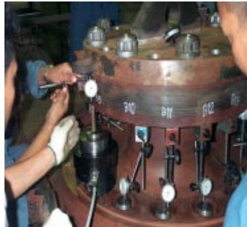
รูปที่ 23 แสดงลักษณะของการยึด Through Bolts ของ Turbine Rotor MW701D (Left) และ MS9161E (Right)
