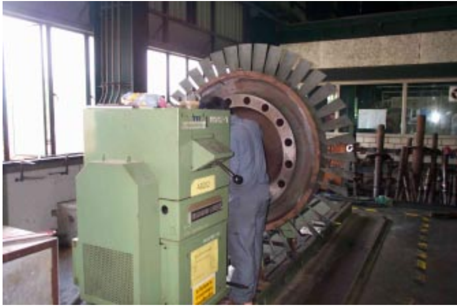
รูปที่ 30 แสดงการตรวจสอบค่า Disc Mass Unbalance โดยใช้วิธี Check แบบ Dynamic
