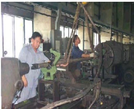
รูปที่ 30 แสดงการตรวจสอบค่า Disc Mass Unbalance โดยใช้วิธี Check แบบ Dynamic
