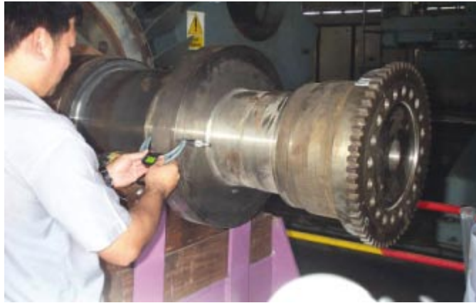
รูปที่ 12 แสดงการวัด Dimension ของ Thrust Collar ก่อนเริ่มงาน
