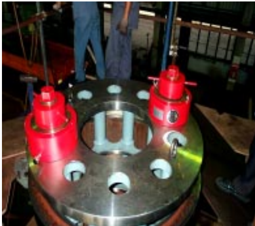
รูปที่ 23 แสดงลักษณะของการยึด Through Bolts ของ Turbine Rotor MW701D (Left) และ MS9161E (Right)
